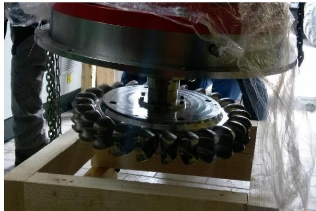
Das neue Kleinwasserkraftwerk mit der eindüsigen Pelton-Gegendruckturbine.
